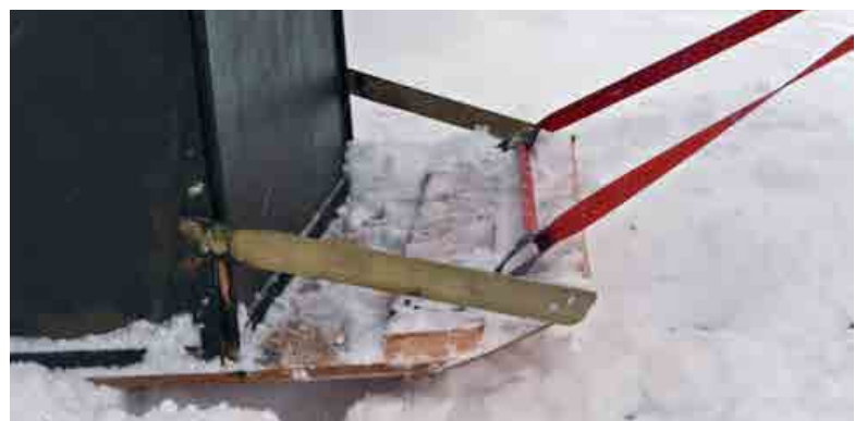
Det går avsevärt lättare att flytta kojan manuellt om man kostar på sig en skiva oljehärdad board under golvet, och böjer upp denna till ett brätte som bilden visar.
